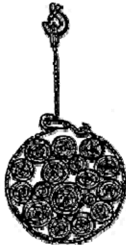
Строповка бревен облегченным стропом со свободным крюком
