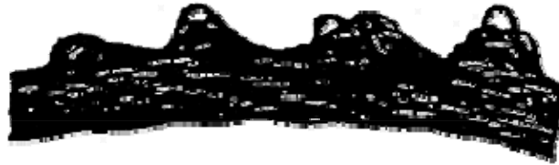
Рис. 11. Выдавливание проволок прядей: а - в одной пряди; б - в нескольких прядях
