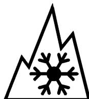
Рисунок 4.3 — Маркировка, наносимая на зимнюю шину
