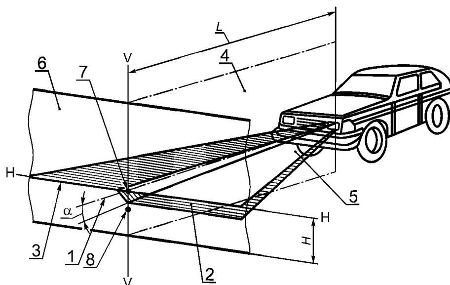
Рисунок 4.2 — Схема расположения КТС на посту проверки света фар, форма светотеневой границы с ломанным правым участком для режима «ближний свет» и размещение контрольных точек на экране
